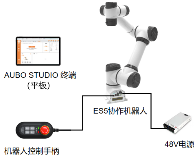
图 5-1 AUBO-ES5 机器人系统
