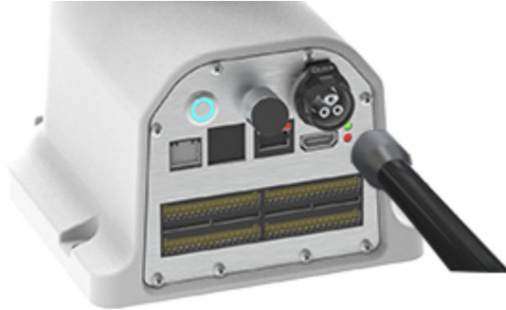
图 10-4 电缆连接至机器人一体化底座
